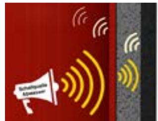
Schallreflexion an Schwer-schicht der Dämmung
