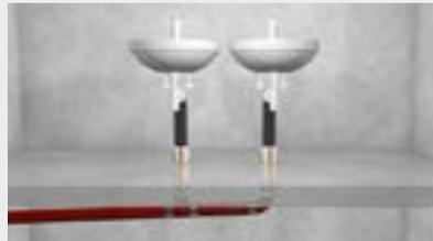
Materialwechsel bei zwei Anschlussleitungen.
