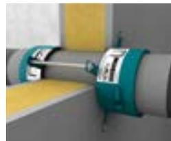
Leichte Trennwände: Bei Montage in leichten Trennwänden Gewindestangen M6 verwenden.
