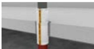
Senkrechter Übergang Guss-Kunststoff-Abwasserleitungen
