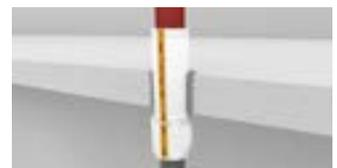
Senkrechter Übergang Kunststoff-Guss-Abwasserleitungen
