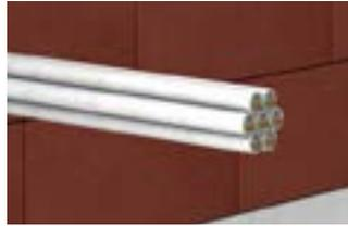
**Fest verschnürte Kabelbündel** bis zu einem Gesamtdurchmesser von 100 mm bestehend aus Mantelleitungen, Telekommunikationskabeln, optischen Faserkabeln mit einem maximalen Außendurchmesser der Einzelkabel von 21 mm (ein Verschluss der Kabelzwicke im Inneren ist nicht erforderlich).
