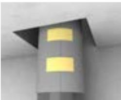
Schaumstreifen mit Klebestreifen um das Rohr befestigen.
